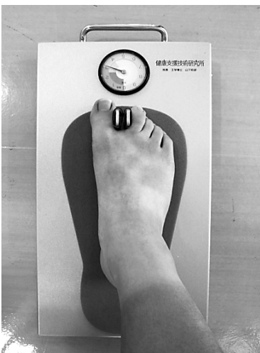
図2 足趾力測定器の外形
